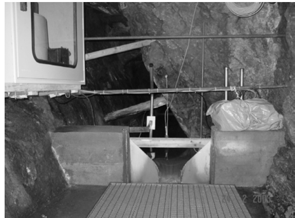
Abb. 4: Versturzpunkt (28) der Haldensickerwässer in den Bereich der Bruchzone (Prinzler/Leimgrübner Gangzug) (links)
